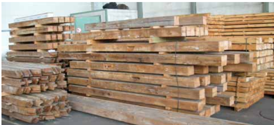
Nyt træ, pommersk fyr, er indkøbt til Kvægtorvet, og noget af det er vindsket i ventetiden.
